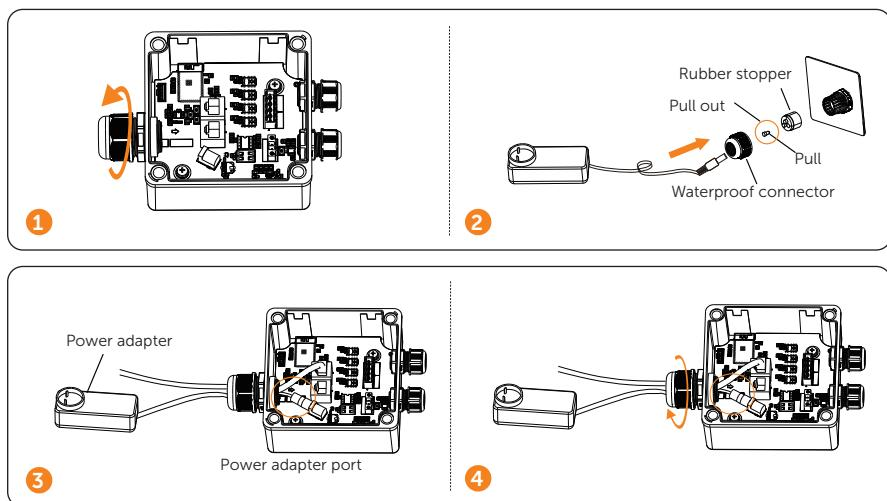
AO Port Connection / Anschluss des AO-Anschlusses / Raccordement au port AO / Conexión al puerto AO / Ligação da porta AO / Aansluiting AO-poort / Collegamento della porta AO / Połaczanie portu AO / Připojení AO portu / AO Portanslutning / AO Port Conexiune / Съвръзане с AO порт / AO-portforbindelse / Σύνδεση θύρας AO / AO-pordi ühendus / AO-portin liitintä / Veza s priključkom AO / AO Port csatlakozás / AO prievedo jungtis / AO pieslēgvietas savienojums / Pripojenie portu AO / Povezava vrat AO
