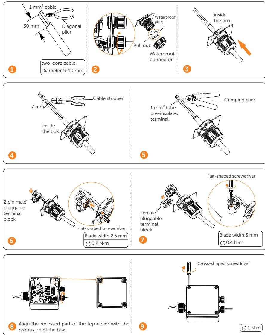
DO Port Connection / Anschluss des DO-Anschlusses / Raccordement au port DO / Conexión al puerto DO / Ligação da porta DO / Aansluiting DO-poort / Collegamento della porta DO / Połączenie portu DO / Připojení DO portu / DO Portanslutning / DO Port Conexiune / Съвръзане с DO порт / DO-portforbindelse / Σύνδεση θύρας DO / DO-pordi ühendus / DO-portin liitääntä / Veza s priključkom DO / DO Port csatlakozás / DO prievedo jungtis / DO pieslēgvietas savienojums / Pripojenie portu DO / Povezava vrat DO
